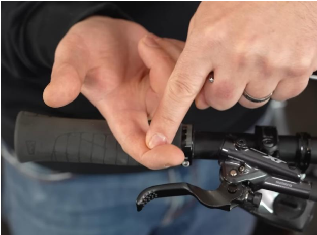
Kraftpunkt im Bremsfinger am Bremshebel
