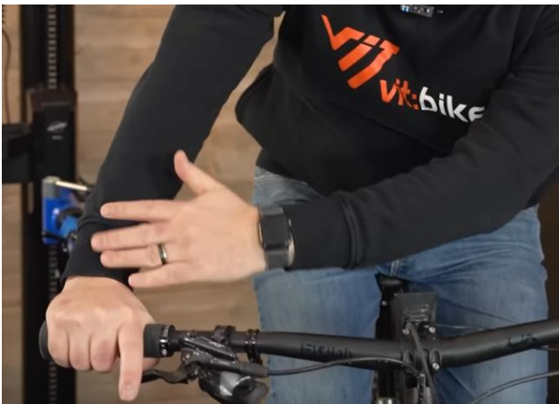
Kraftpunkt im Bremsfinger am Bremshebel
